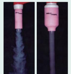
標準コレットボディ(左)と大口径ガスレンズコレットボディ(右): ガス流量6L/min.
